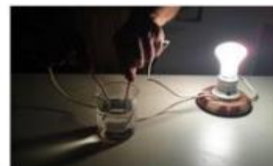
Teste da lâmpada em uma solução concentrada de cloreto de sódio
