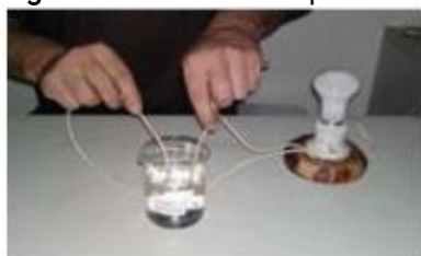
Teste da lâmpada em água destilada
